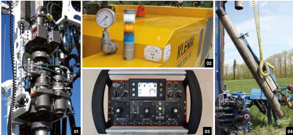
01 Doppelkopfbohranlage // double head drilling unit 02 Signalsäule für Betriebsarten EN 16228 // signal lights for operation modes EN 16228 03 Funkfernsteuerung // radio remote control with display 04 Gestängehandhabungssystem HBR 180 // rod handling device HBR 180
