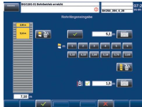
Mit dem Bildschirm für die Erfassung der Bohrröhre behält der Gerätefahrer zu jedem Zeitpunkt die Übersicht über den gesamten Bohrrohrstrang. Durch Setzen eines Schwellenwerts wird er frühzeitig optisch darauf hingewiesen, wenn ein weiteres Bohrrohr einzudrehen ist.
