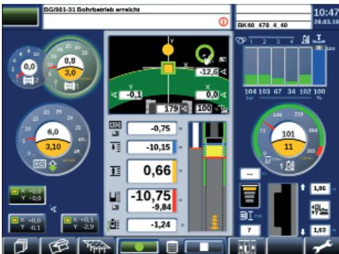
Auf das Kellybohren abgestimmte Anzeigen im Arbeitsbildschirm zeigen die jeweils relevanten Parameter in übersichtlicher Anordnung. Besonderheiten, wie die Kellyvisualisierung oder die auf die eingesetzte Kellystange abgestimmte Drehmomentanzeige unterstützen den Gerätefahrer im sicheren Betrieb.
