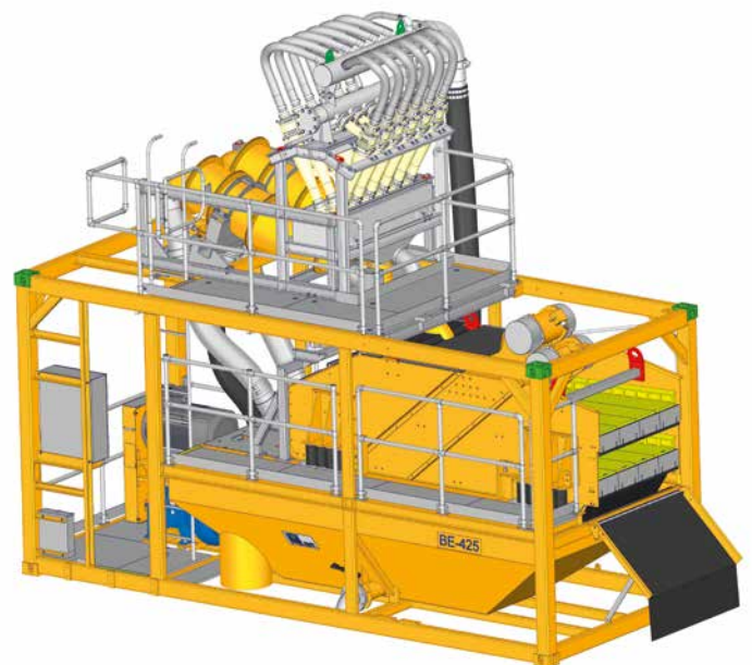
BE 425-60 mit Desilter BE 425-60 with desilter
