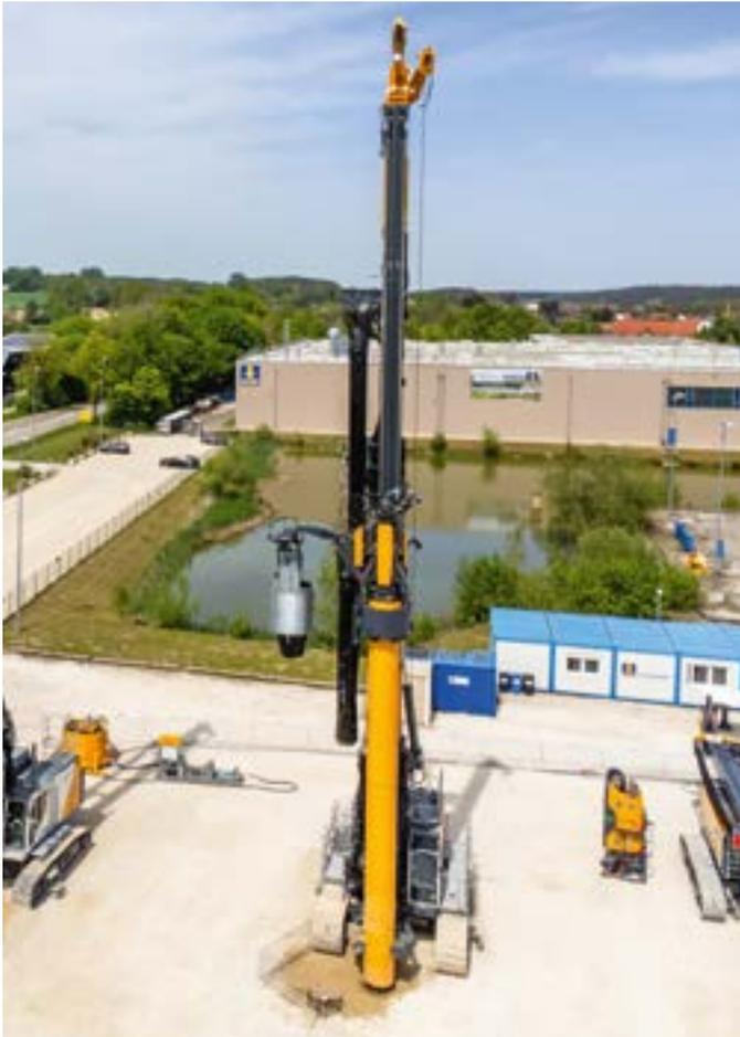
RTG Geräte sind wegen ihrer drehbaren, stabilen Mätkler und der großzügigen Hydraulikleistung sehr gut als Trägergeräte für verschiedene Bohrverfahren einsetzbar. Dazu sind bei RTG Rammtechnik eine Reihe von Bohrantrieben verfügbar.
