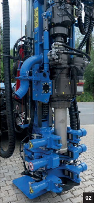
01 KR 708-3GW 02 Klemm- und Brechvorrichtung // clamping and breaking device 03 Maschinenüberwachung // machine monitoring 04 Manometerbox // manometer box
