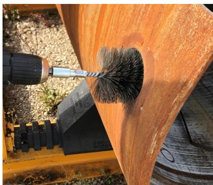
Abbildung 1: Reinigungsbürste im Betrieb
