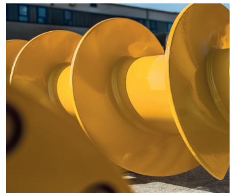
Schneckenwendeln mit Auftragsschweißung Auger flights with hard facing
