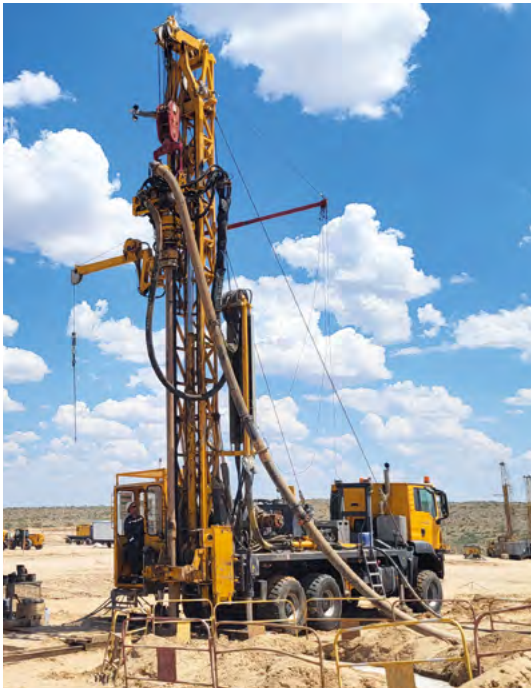
RB 65 – Produktionsbohrungen im Bergbau RB 65 – production wells in mining
