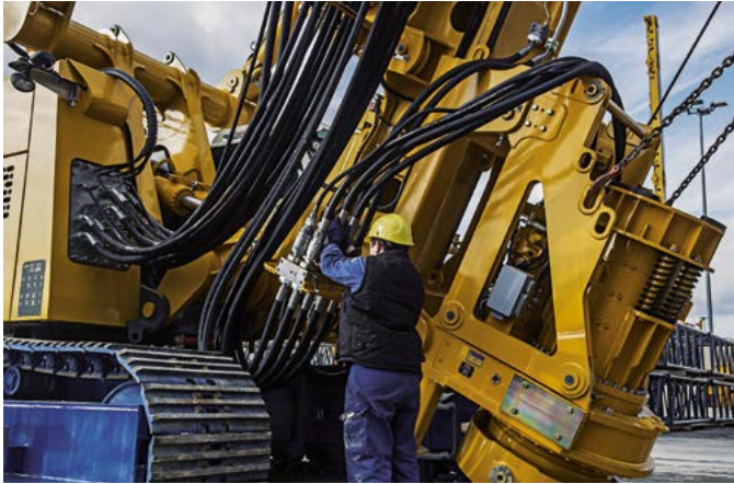
Aufbaustellung zum Anschluss der Hydraulikschläuche
