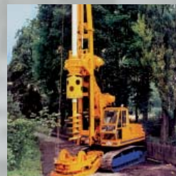
1976 Erstes Großdrehbohrgerät BAUER BG 7
