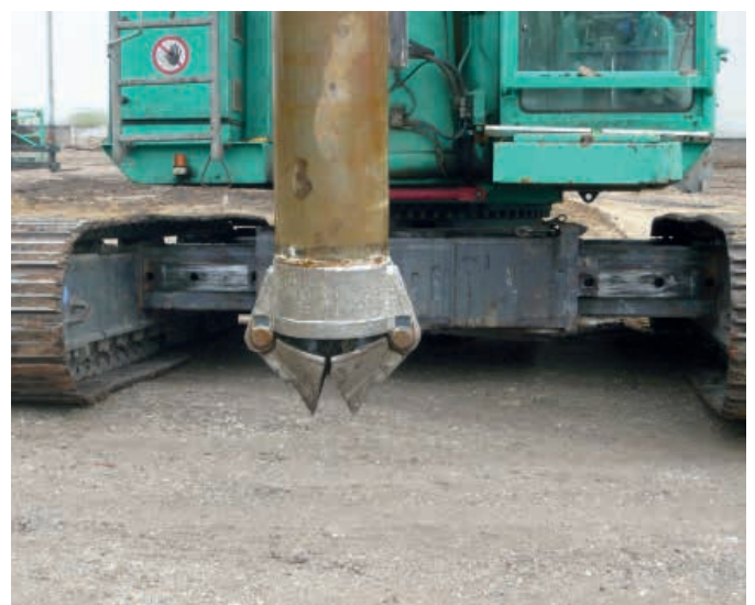
Klappe an der Spitze des Rüttelrohrs
