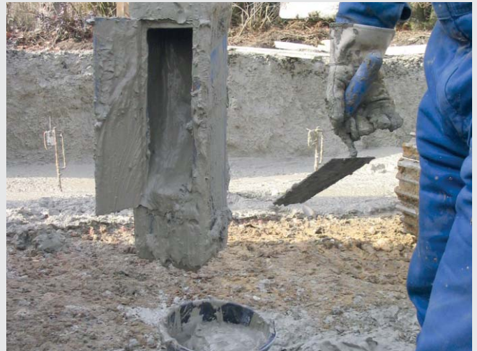
Entnahme von Frischproben mit einem Probenentnahmewerkzeug
