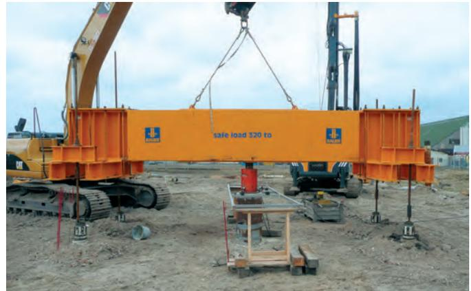
Pfahlprobelastungsrahmen für eine maximale Belastung von 3200 kN
