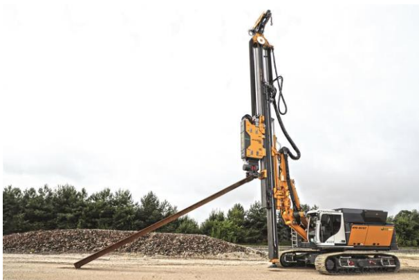
(1) Der Spundbohlenassistent ist ein effektives Tool für das exakte und schnelle Aufnehmen der Spundwandelemente.
